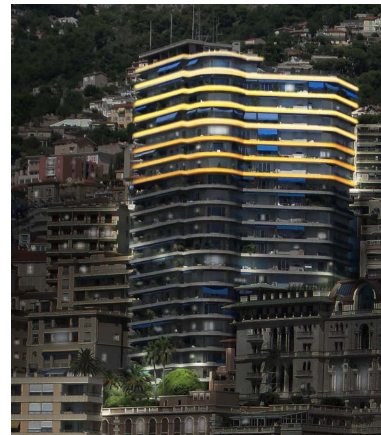
Exemple de mise en lumière, infographie, de l'immeuble Le Schuykill. Puissance installée estimée à 5kW pour un ratio de 10W/ml
